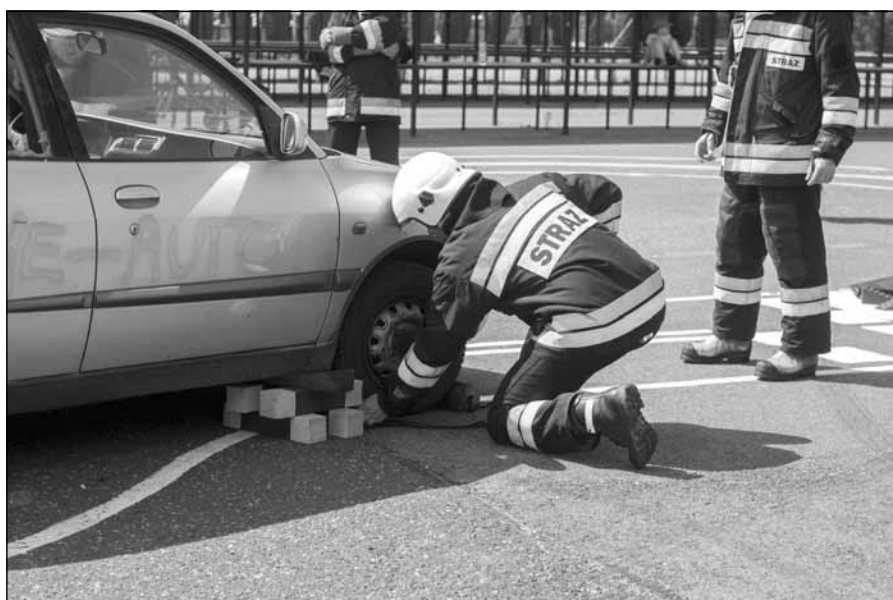
Stabilizacja i unieruchomienie pojazdu od strony pasażera.
