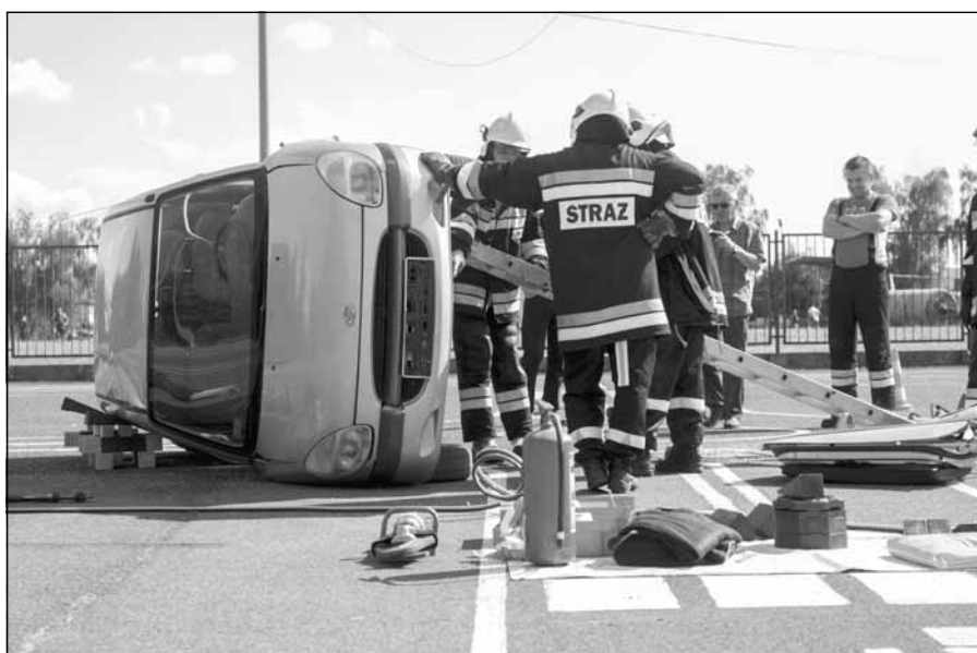
Wykonanie stabilizacji pojazdu na boku z użyciem dostępnych środków.
