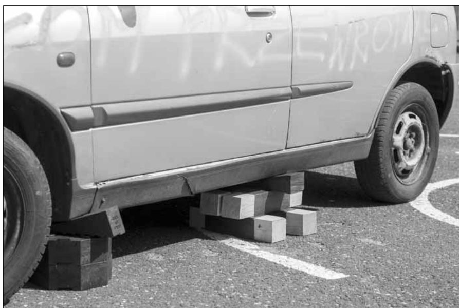
Podbudowa stabilizująca od strony kierowcy.
