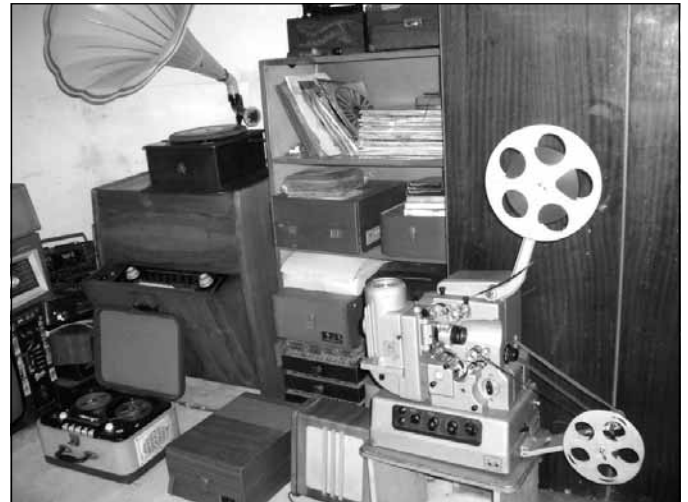
Na pierwszym planie projektor filmowy. To urządzenie z zieloną tubą to patefon. Jest to przenośne urządzenie o napędzie mechanicznym do odtwarzania dźwięku z płyt, wynalezione przez braci Emila i Charlesa Pathe, produkowane w latach 1905-1920 przez firmę Pathe Freres.
