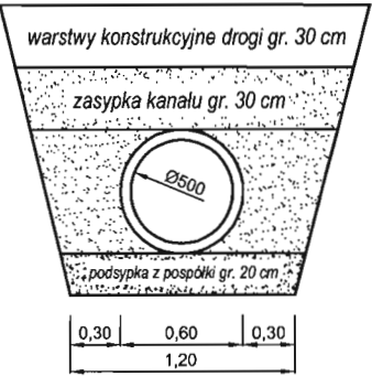
PRZEKRÓJ KOLEKTORA RUROWEGO SKALA 1:40
