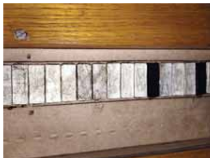
Spleśniałe i stwardniałe membrany (czarna naprawiana)
