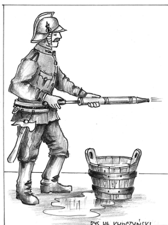
Gaszenie pożaru sikawką podręczną z drewna (szprycą). Każdorazowo woda do szprycy, zasysana była z drewnianej konwi wypełnionej wodą. Konew zawsze ustawiona była obok strażaka, a wodę dolewano do niej wiadrami lub konewkami.
